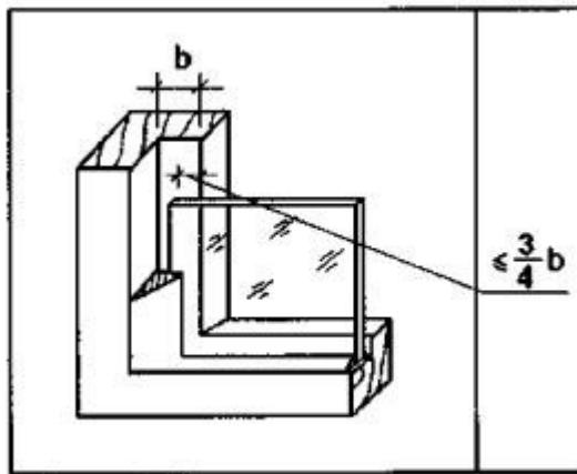
Замазка после образования на поверхности твердой пленки не должна иметь трещины, отставать от поверхности стекла и фальца.
