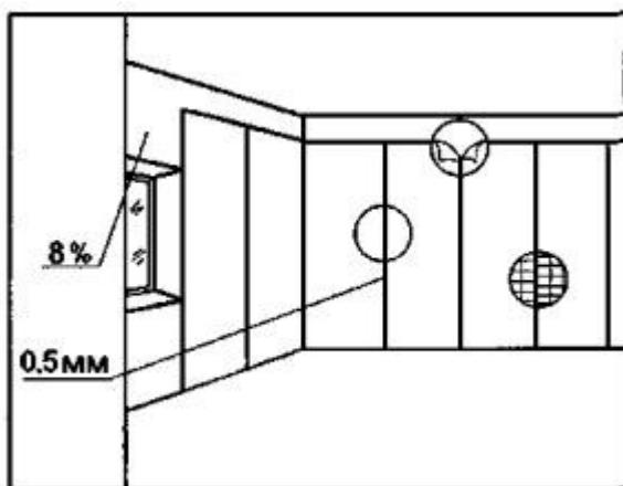
Допускаемая влажность бетонных, оштукатуренных или прошпатлеванных поверхностей при оклейке обоями - не более 8 %.
